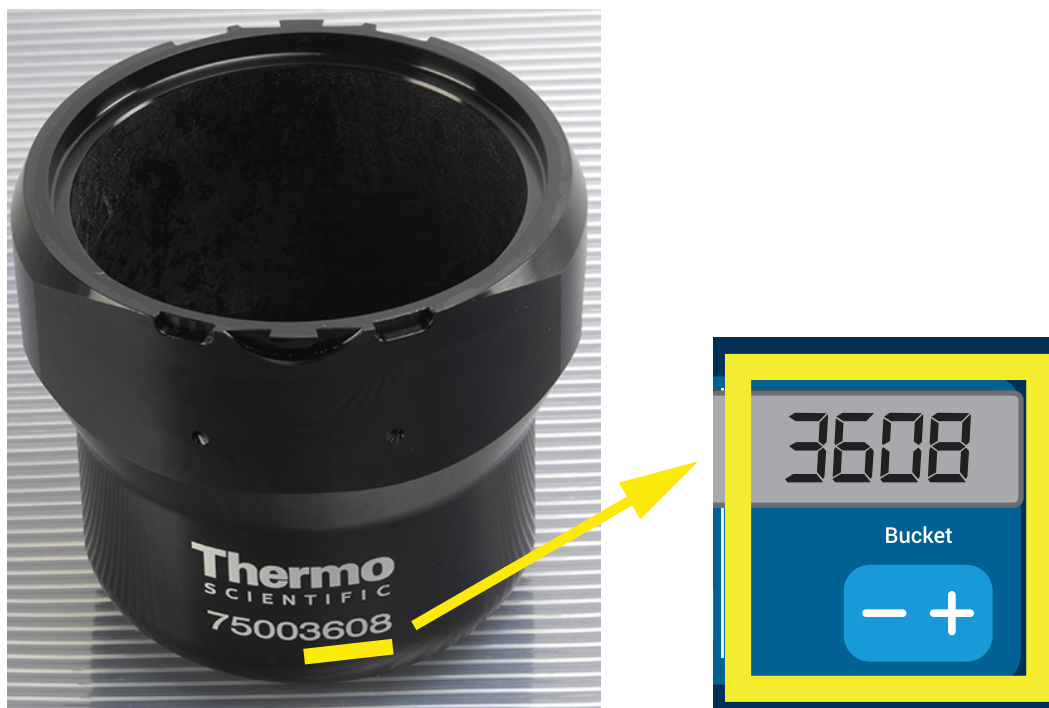
Afbeelding 4–8: Correcte bekercode voor de rotor instellen
