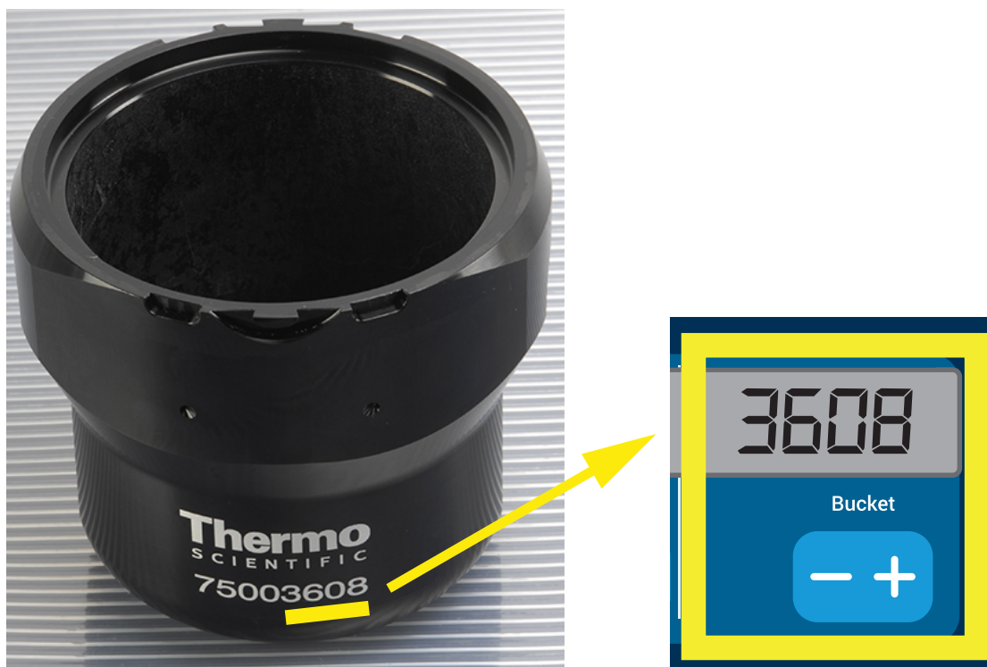
Afbeelding 2-15: Correcte bekercode voor de rotor instellen
