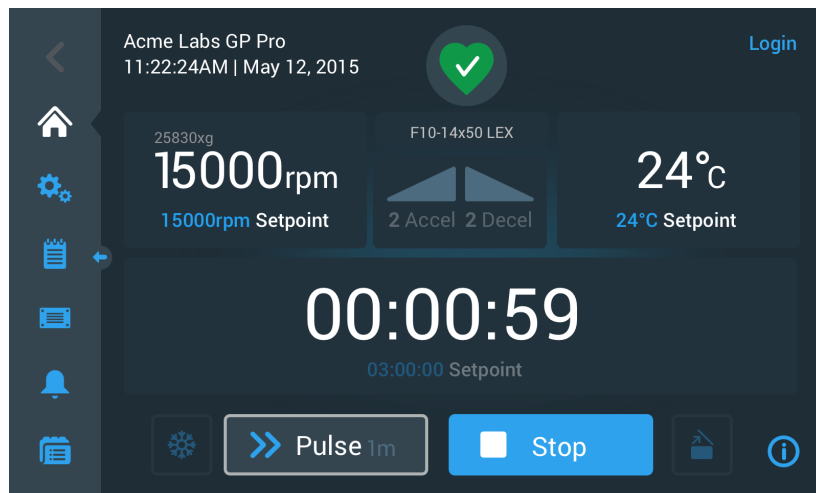
Afbeelding 3-25: Pulse-modus: Centrifuge draait een minuut lang
