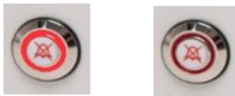
Figuur 14.1 Alarmtoets die de alarmconditie aangeeft
