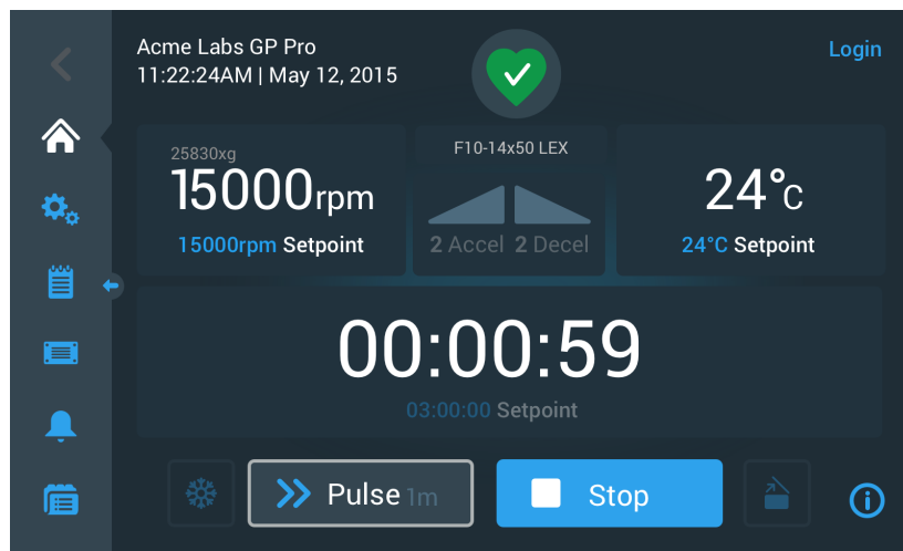
Afbeelding 3-25: Pulse-modus: Centrifuge draait een minuut lang
